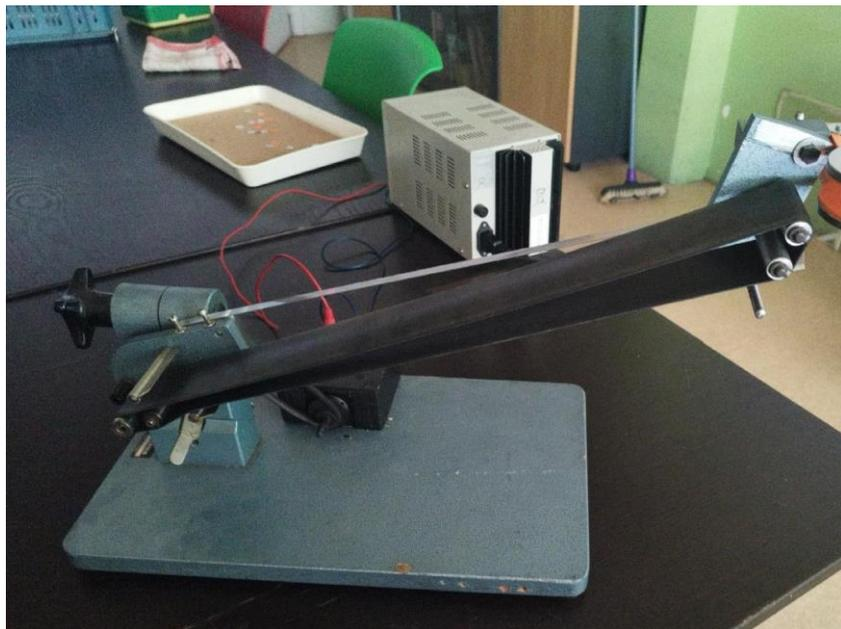
**Figure 3** : Photo du séparateur à courant de Foucault
