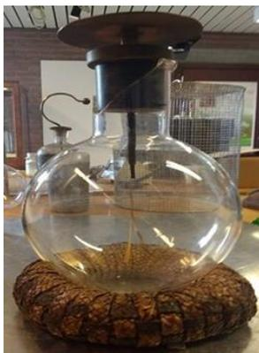
Dans l'ampoule se trouvent deux fines feuilles de papier aluminium reliées à une base métallique. Il est alors neutre.
