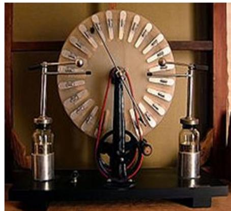
*Connectons maintenant une des bornes de la machine à une tige métallique placée au centre d'un anneau lui-même connecté à la deuxième borne. Que se passe-t-il ?*
