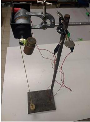
Une génératrice est fixée en hauteur à l'aide d'un statif. D'un côté on y connecte une LED et, de l'autre, on place une ficelle reliant deux masses différentes.
