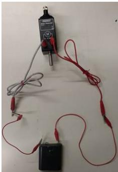
A/ Connecter la pile au moteur
