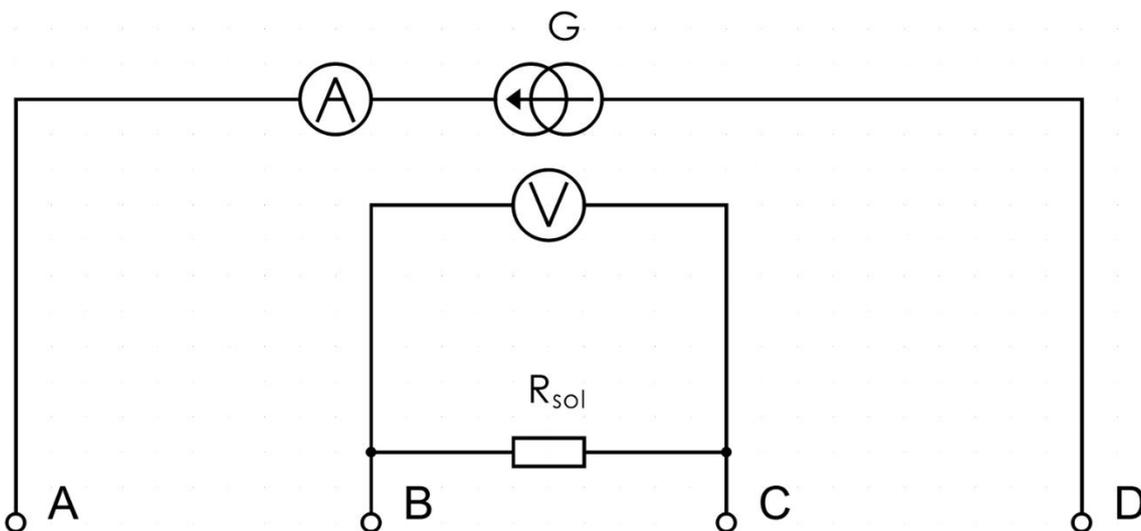
Du courant électrique est injecté par le générateur au circuit primaire G, la valeur ( $I$ ) est contrôlée par l'ampèremètre et circule entre les électrodes A et D. Ce faisant, il traverse la zone occupée par les électrodes B et C et induit donc un courant électrique dans le circuit secondaire, dans lequel le voltmètre permet la mesure ( $V$ ). C'est le rapport de ces quantités  $\rho = \frac{V}{I}$  qui représente la résistivité apparente.
