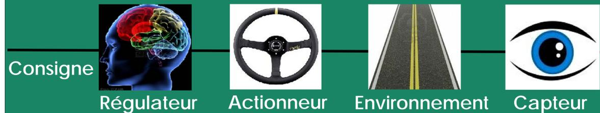
La consigne est de rouler droit. Le cerveau (régulateur) analyse l'erreur et tourne le volant (commande à l'actionneur) qui réaligne la voiture sur la route. Les yeux (capteur) détectent les déviations et envoie l'information au régulateur.
