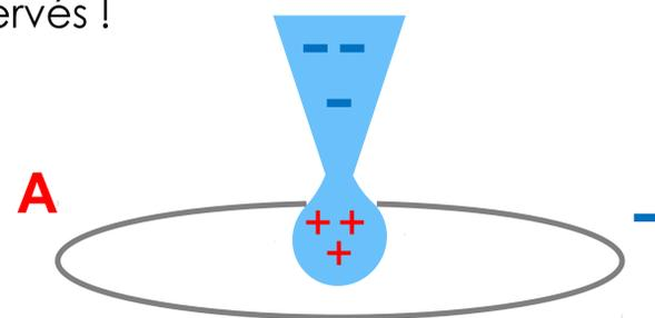
Pendant toutes les étapes du fonctionnement, c'est la force de gravité qui prédomine en forçant les ions présents dans l'eau à chuter. En effet, les charges tendent à remonter, les ions positifs suivant le sens du champ électrique E et les négatifs allant à son encontre.
