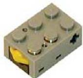
Capteur de contact: c'est le capteur le plus simple. Comme l'interrupteur d'une lampe, s'il est touché alors le courant ne passe plus. Il indique au robot si il a cogné un objet.
