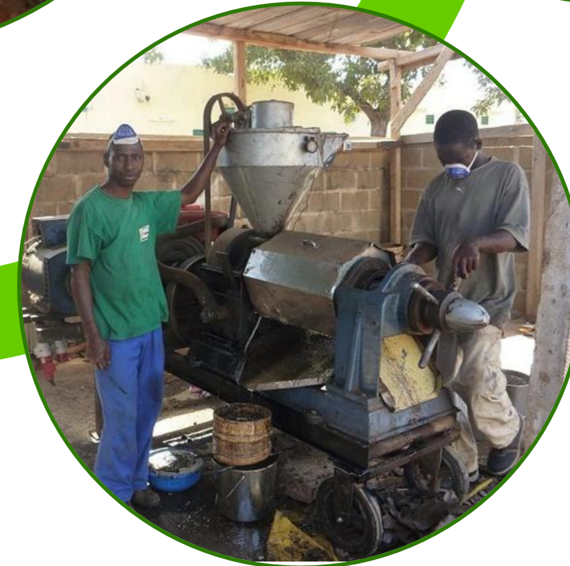
Presse à anneaux utilisée pour les essais de pressage
