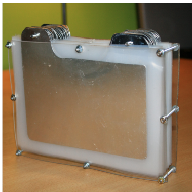
(a) Condensateur à plaques "artisanal"
