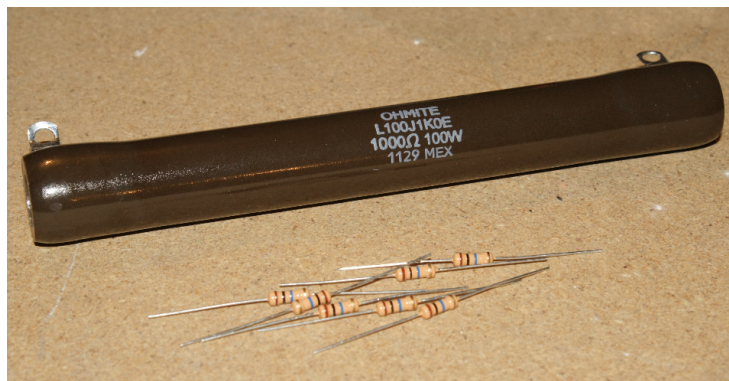
FIGURE 1.2 – Deux types de résistances utilisées dans la bobine de Tesla
