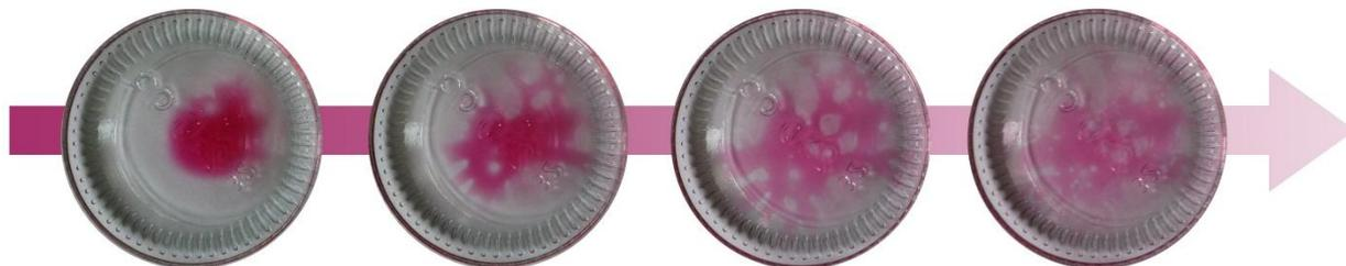
La diffusion moléculaire est un phénomène très courant qui tend à rendre homogène tout fluide qui ne l'est pas (Fig. 3). Ainsi, lorsque nous déposons une goutte d'encre dans de l'eau, par exemple, on observe très rapidement que l'encre se disperse dans l'eau alors même qu'on ne lui a communiqué aucun mouvement.
