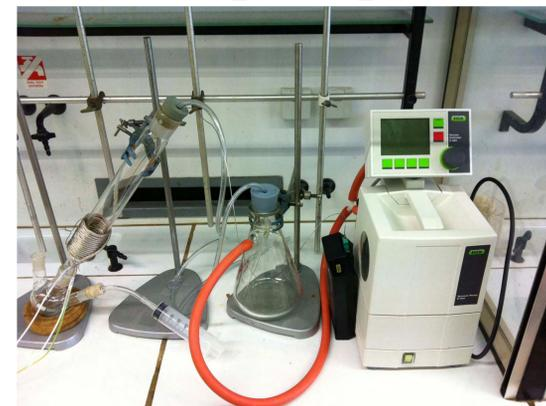
Le mélange est poussé à travers un fragment de pot catalytique et est converti en N<sub>2</sub>, CO<sub>2</sub> et H<sub>2</sub>O (gaz non toxiques).
