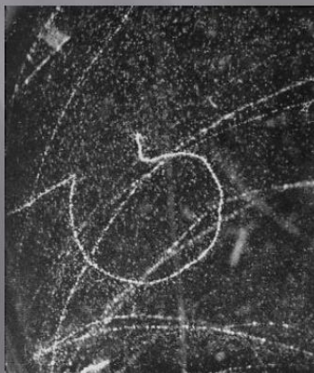
Electron dévié par un champ magnétique
