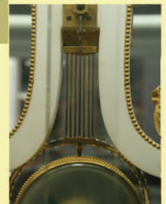
Balancier à grille de zinc et d'acier
