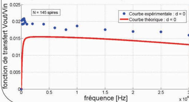
Tensions théorique et pratique en fonction de la fréquence dans la bobine de fin fil
