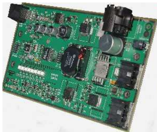
Carte ATMEL , contenant entre-autres un processeur et un peu de mémoire. Support utilisé pour donner les instructions au robot
