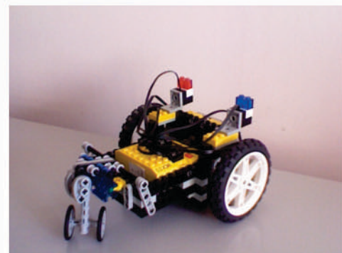
Robot Mindstorm Line Follower (suiveur de ligne)
