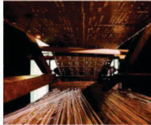
Métier à tisser fonctionnant avec des cartes perforées
