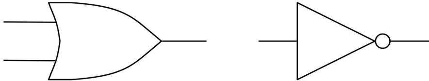
On combine ces portes logiques, en reliant les entrées et les sorties les unes aux autres. On identifie aussi clairement les entrées et les sorties du circuit. Par exemple, si on considère  $p$  et ( $q$  ou  $r$ ), on a trois entrées  $p$ ,  $q$  et  $r$ , et une seule sortie. On dessine alors quelque chose comme :
