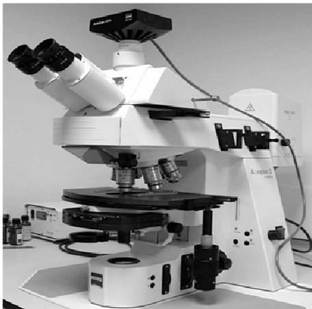
Le microscope à fluorescence permet de localiser plusieurs molécules différentes simultanément et éventuellement de suivre leur parcours. Contrairement au microscope confocal, le microscope à fluorescence détecte les fluorochromes dans toute l'épaisseur de l'échantillon. Il peut être utilisé aussi pour des études de matériaux et de surfaces.
