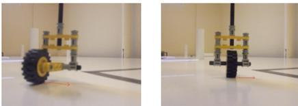
La roue de gauche est désaxée et peut donc tourner alors que la roue de droite ne fera que frotter sur le sol.
