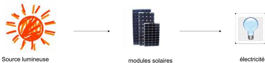
Cette conversion peut se faire grâce à **des cellules photovoltaïques** (principe découvert en 1839 par A. Becquerel )
