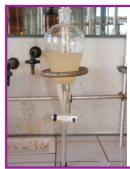
Extraction: Le principe de l'extraction se base sur les différentes interactions de l'arôme pour deux phases liquides non-miscibles.
