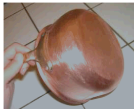
Nettoyage de la casserole avec de l'acide chlorhydrique (HCl)
