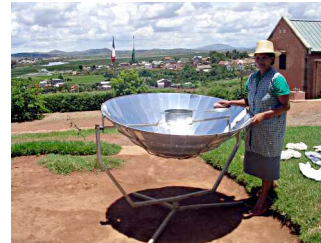
Le four solaire utile pour la cuisine
