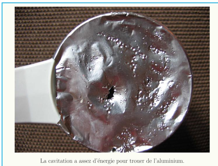
La cavitation a assez d'énergie pour trouser de l'aluminium.
