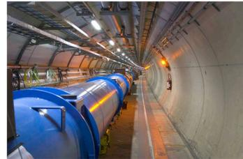
câble supraconducteur. Ils seront traversés par des courants de 40 000 A, pour produire des champs de 10 T. L'un des détecteurs associés, le CMS, détient le record du monde : 4 Tesla sur un volume de  $460 \text{ m}^3$ . L'énergie stockée serait capable de soulever la tour Maine-Montparnasse de 2 m, ou de satelliser un homme sur la station spatiale internationale !
