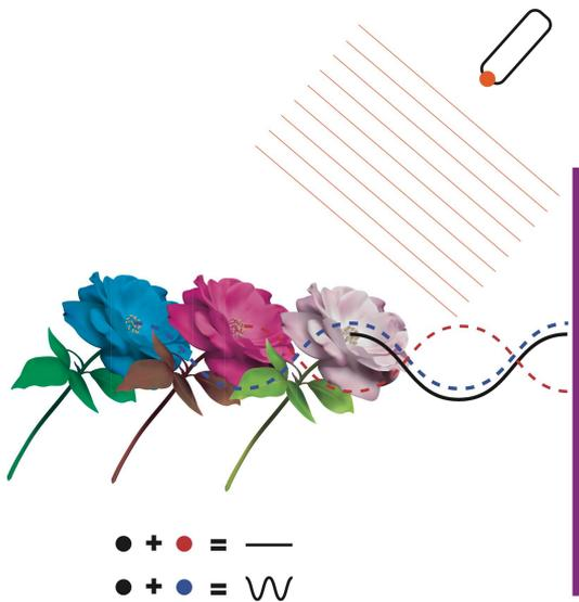
Imaginons un objet que l'on déplace juste après l'avoir holographié. Si on l'holographie à nouveau sur la même plaque, on produit alors une interférence entre les deux prises de vues, selon le principe d'addition des ondes lumineuses.
