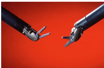
Au bout des bras du robot, les micro-outils. Leurs articulations permettent de les orienter dans tous les sens.
