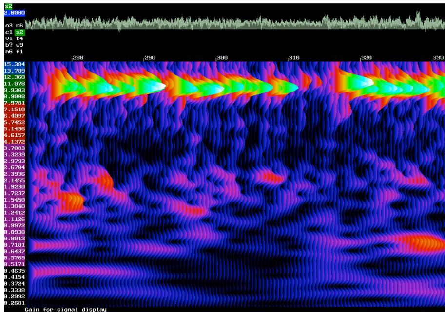
ECG: Signal mesuré et contenu en fréquence (Transformée de Fourier) à chaque instant
