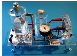
Modèle d'une pile à combustible
