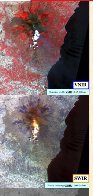
Images du satellite ASTER de l'éruption de l'Etna le 29 juillet 2001 (10:01 UTC). ASTER (Advanced Spaceborne Thermal Emission and Reflection Radiometer) est un radiomètre multispectral à haute résolution installé à bord du satellite TERRA de la NASA et qui enregistre des images à haute résolution spatiale (respectivement de 15m pour VNIR, 60m pour le SWIR et 90m pour TIR).
