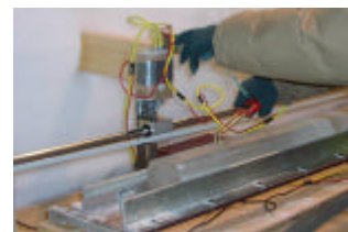
Source: Mesure de la conductivité électrique en courant continu sur une carotte du sondage North GRIP (Photo: J.-L. Tison)
