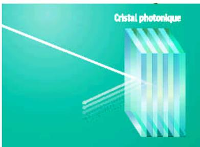
En optique, un cristal photonique peut être obtenu par une alternance de couches minces de deux matériaux d'indice de réfraction différent.
