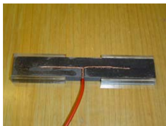
Collecteur-balai : carbone relié à un fil électrique
