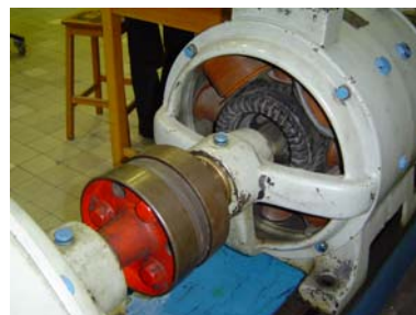
Vue des électroaimants : un courant passant dans des spires crée un champ magnétique.
