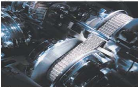
Système utilisant une chaîne à la place de la traditionnelle courroie (AUDI MULTITRONIC)
