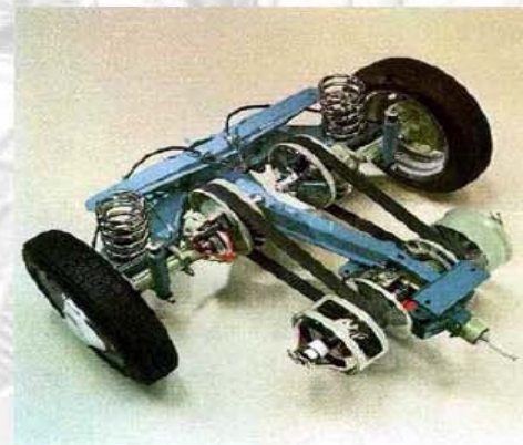
Système utilisant une chaîne à la place de la traditionnelle courroie (AUDI MULTITRONIC)
