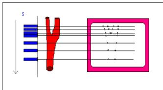
Principe de l'échotomographie : le déplacement de la sonde permet de construire, dans un même plan, plusieurs lignes d'exploration, donnant naissance à une image en deux dimensions.
