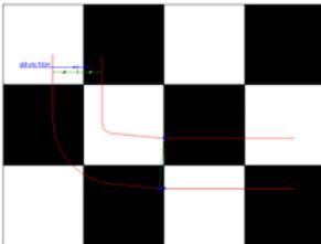
Le robot se déplace perpendiculairement aux lignes des carrés. Il utilise les transitions de couleurs (noir/blanc) pour se réorienter. Si une roue du robot passe avant l'autre sur une transition (ligne), elle ralentit pour permettre au robot de pivoter. Une fois que l'autre roue passe sa transition, la première reprend la vitesse de croisière pour repartir en ligne droite.
