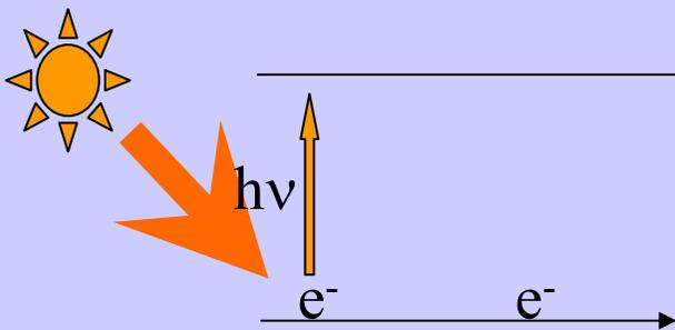
Sous l'action de la lumière, un électron est excité et passe à un niveau d'énergie supérieur.
