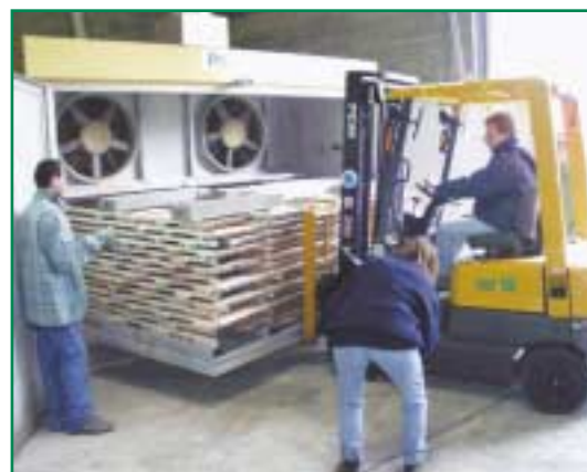
Mise en place d'une charge de planches dans la cellule de séchage.
