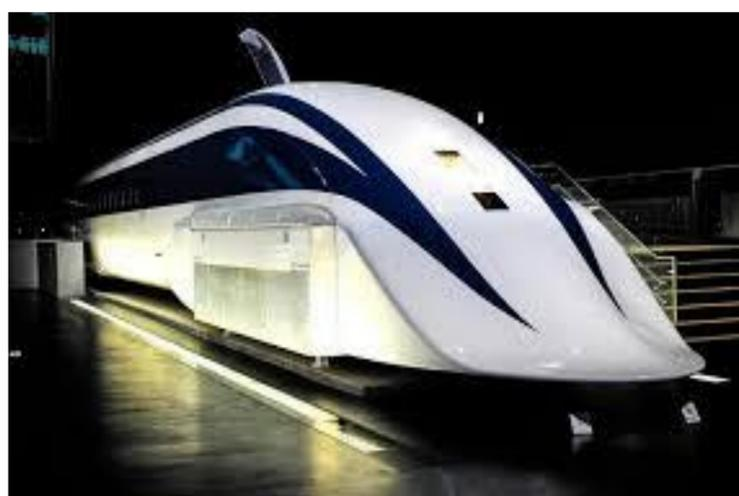
La lévitation magnétique permet de créer des champs magnétiques qui soulèvent et propulsent les trains sans contact avec les rails. Cela réduit la friction, permettant des vitesses élevées et un fonctionnement silencieux.
