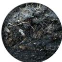
**Le charbon actif à base de tourbe** est produit en chauffant la tourbe à haute température. Les pores de ce type de charbon actif sont de **taille moyenne**.
