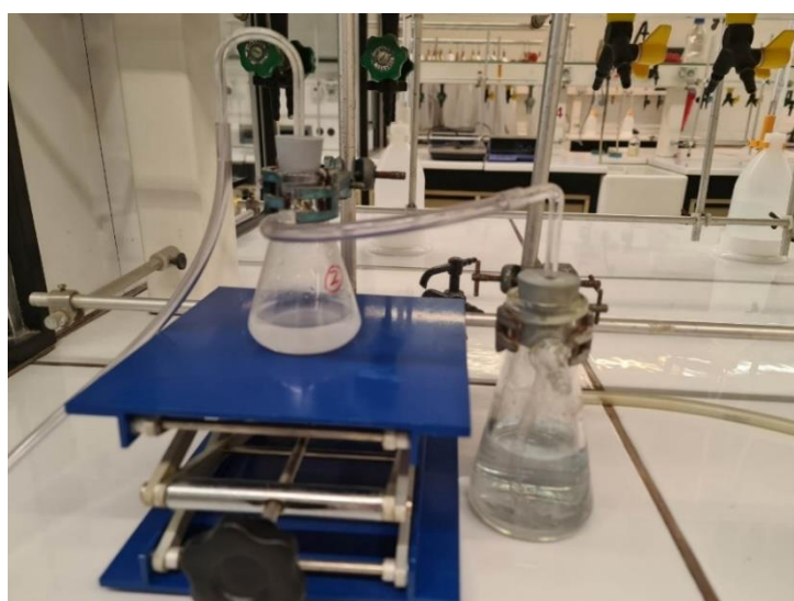
Figure 1 : Photographie du montage expérimental illustrant le principe de dépollution par absorption
