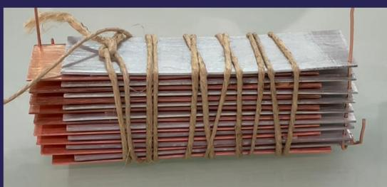
Montage des plaques d'aluminium et de cuivre liées par une ficelle et séparées par des petits bouts de bois.
