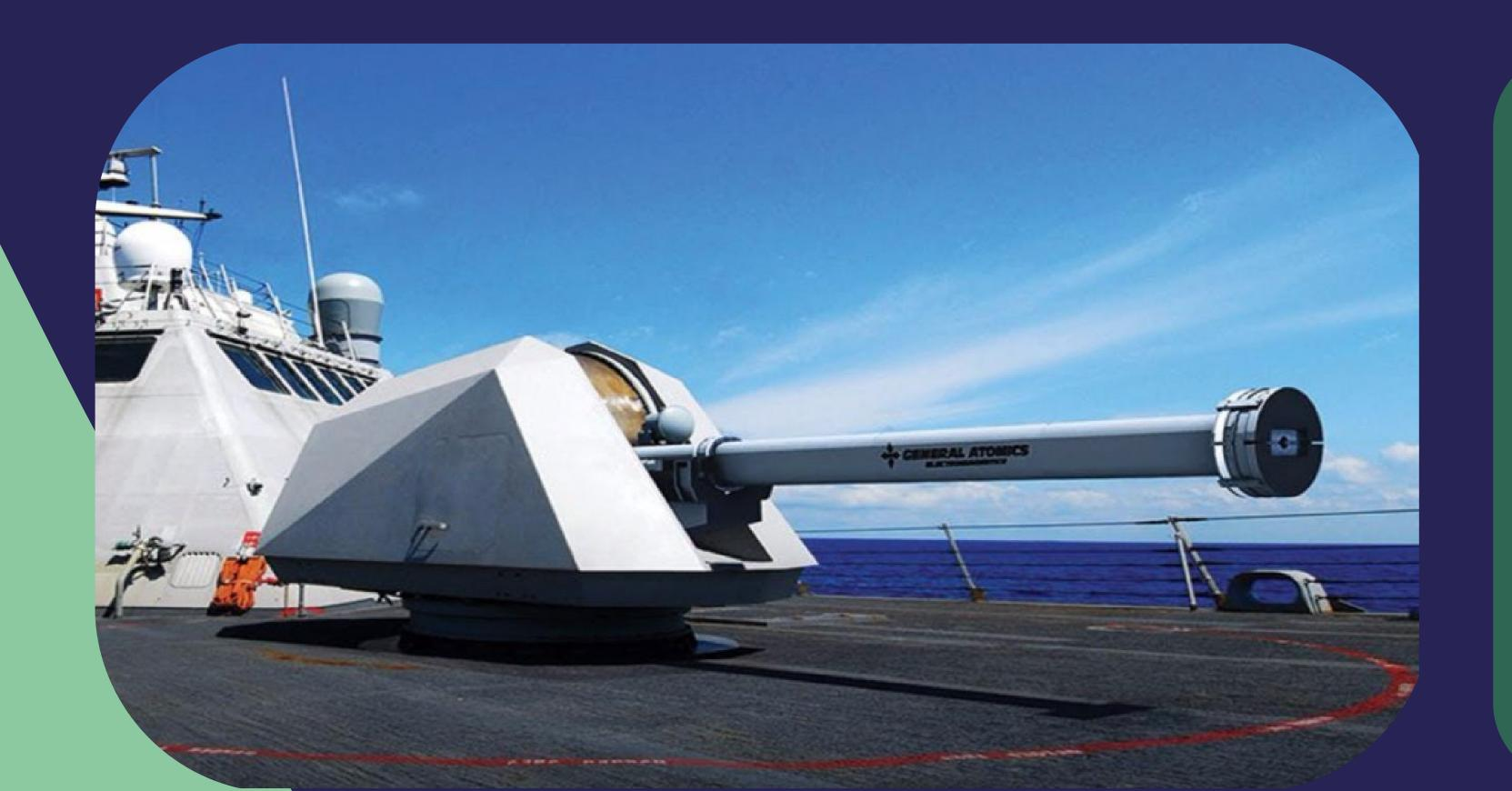
Ceci est un vrai railgun. lci il appartient à la U.S.Navy. Dans ce type de railgun pas besoin d'aimants! En effet le courant qui traverse le rail est suffisamment élevé que pour généré un champ magnétique! La force de Lorentz et la regle de la main droite restent d'application!
