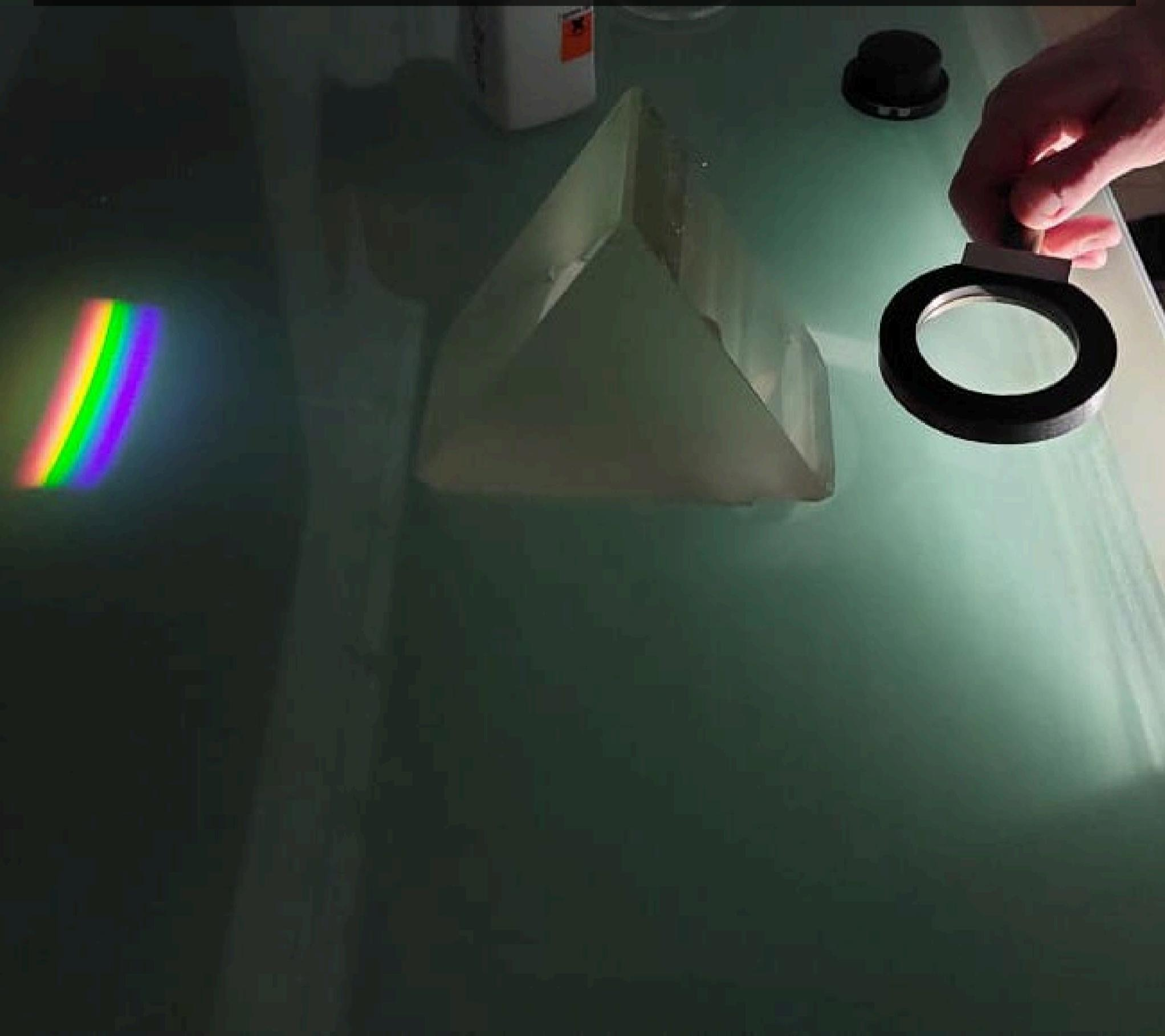
Cette manipulation introduit la spectroscopie et montre un exemple de son application pour l'exploration de l'infiniment grand et de ses constituants. L'expérience consiste en la création de son propre spectromètre à l'aide de matériel facile d'accès avant d'analyser le spectre obtenu par la désexcitation de certains constituants de sels (ici, des atomes).
