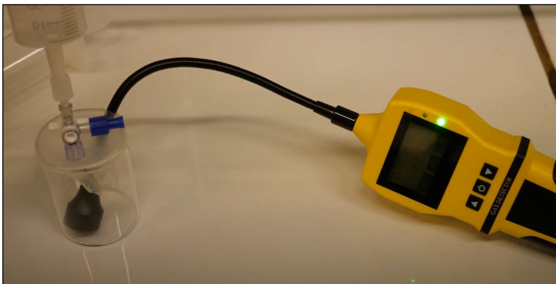
Figure 6 : Montage pour le détecteur de méthane.
