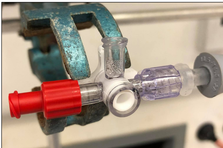
Figure 11 : Présence de gouttes d'eau formées par la réaction de Sabatier dans l'embout féminin de la valve à trois voies.
