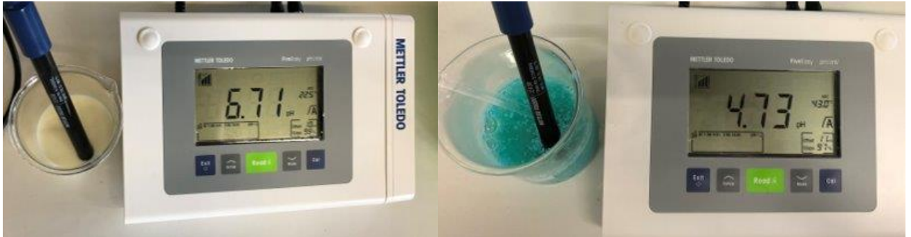
Figure 7 : Mesure du pH avant acidification du lait (panneau de gauche), mesure du pH après acidification du lait (panneau de droite)
